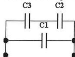
$C_1=250 \text{ pF}; C_2=C_3=125 \text{ pF}$
